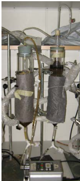
Figur 3. Försöksuppställning, torrötning i två-stegsprocess med lakbäddsreaktor till vänster och UASB-reaktor till höger i bilden.
