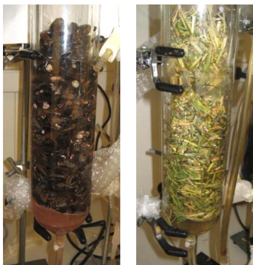
Figur 4. Laktbäddsreaktorer med blåmusslor och vass.
